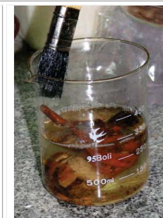
صورة (١٤) توضح تقوية تماثيل المركب الثاني الهشة بطريقة الغمر.
