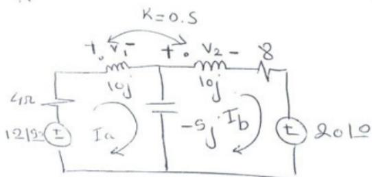
$$12 19^\circ - 4 I_a - 10j I_a - (-5j)(I_a - I_b) - v_1 = 0$$
